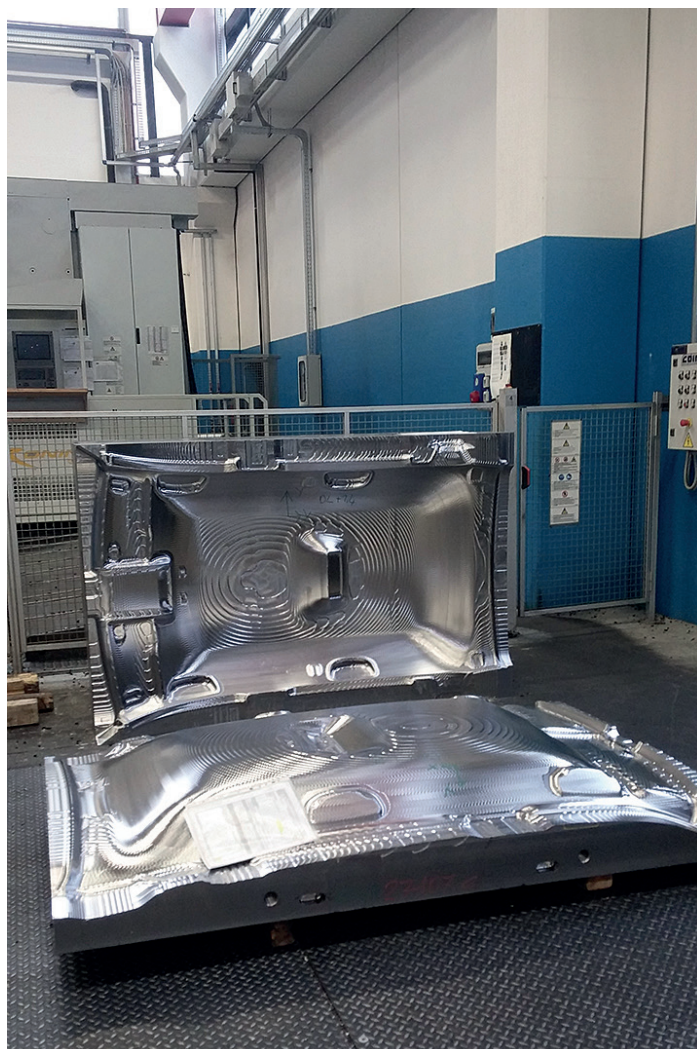
Stampo per formatura di padiglioni in costruzione.
