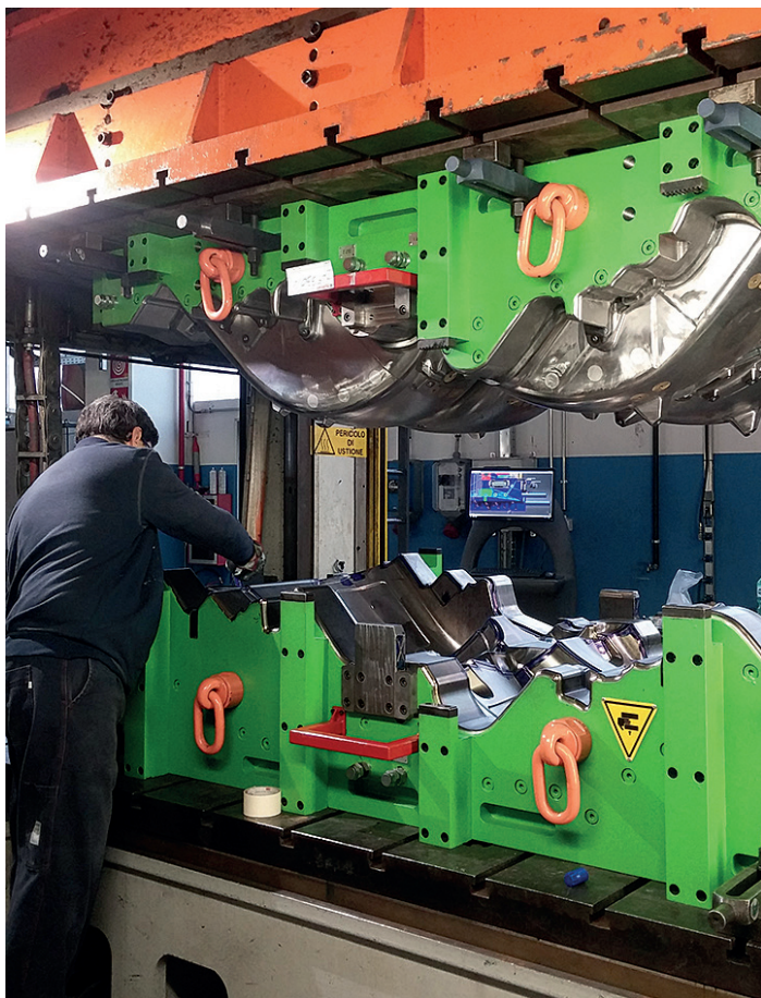
I dispositivi anti-caduta Sitema vengono impiegati quando è necessario assicurare carichi sospesi contro una caduta o un abbassamento involontario.
