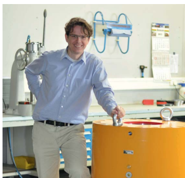
Карстен Ротер, руководитель службы сбыта SITEMA, с гордостью представляет фиксатор KFH 300 с удерживающей силой 2200 кН. На сегодня это крупнейший гидравлический фиксатор, выпущенный на заводе в Карлсруэ.
