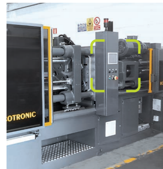
Moldeadora por inyección Para cerrar el molde y generar la fuerza de cierre
