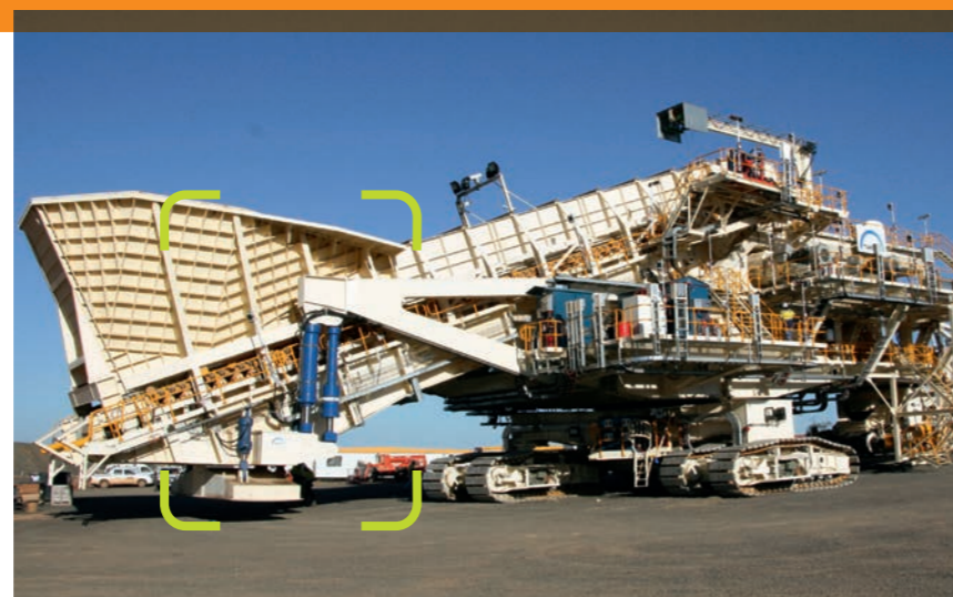
Equipo hidráulico móvil Trituradora de lignito en una mina de carbón a cielo abierto en Australia
